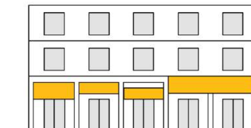
同一建筑物的门面招牌广告的规格、形式、位置不统一，高度不一致，广告牌宽度没有以建筑开间为单元(×)
