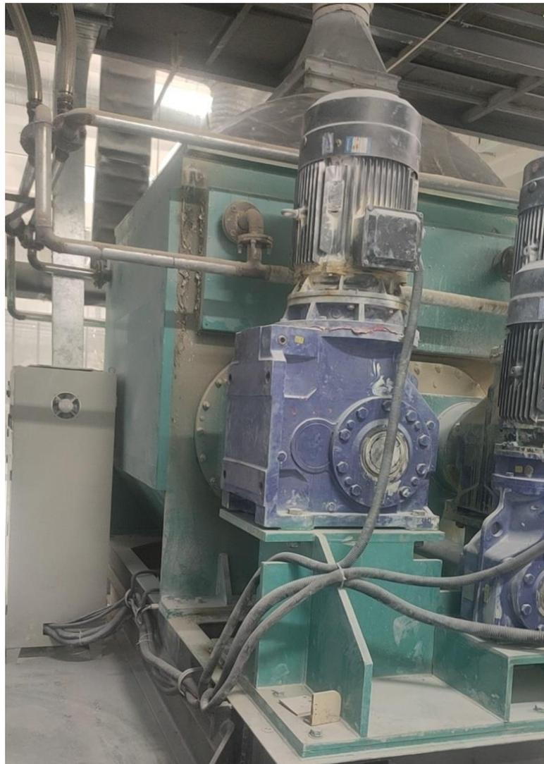
图 2-6 捏合机和废气收集
